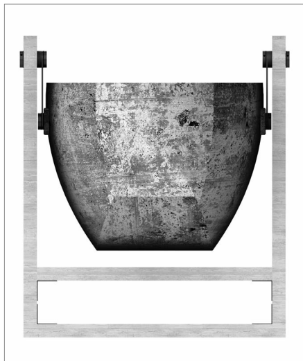
2. ábra A fa tartószerkezetbe függesztett bölcsőkagyló előnézete: a bölcső felfüggesztett állapotban lengő mozgást tud végezni, mely négy kar segítségével történik. A bölcső így nyugvó pozíciójához képest oldalirányú mozgást végez, a gyermek fekvési tengelyével párhuzamosan.
