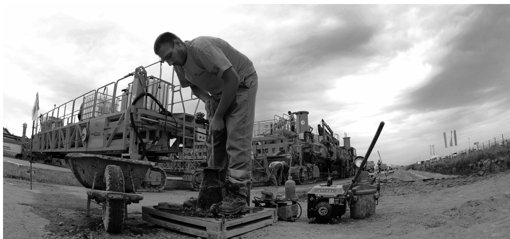
4. ábra Az akkreditációs státusz kiterjed többek között a roskadás, valamint a tömörödési tényező mérésre is
