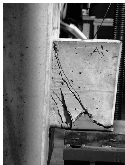
3. kép A konzoloknál is próbatétel sorozata kellett a megbízható biztonságához. Ennél a konzolnál a törés 650 kN tehernél következett be
