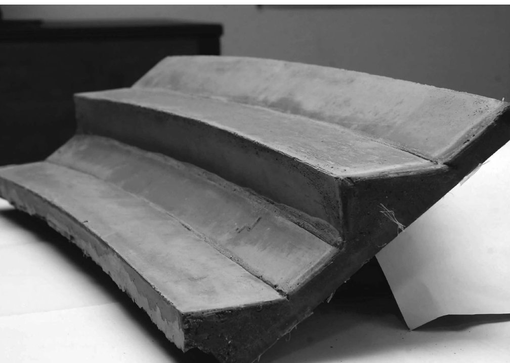
1. kép Lelátó elem 1:10 léptékben, de már betonból, az elképzelt gyártástechnológiával gyártva
