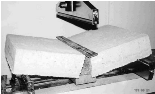
12. ábra Mederlap hajlító-húzószilárdság vizsgálata
