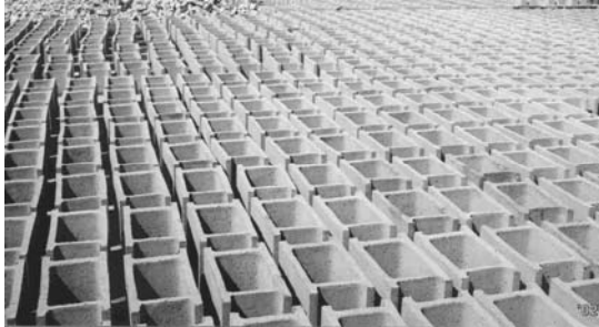
11. ábra Bontott adalékanyagú betonból gyártott zsaluzóelemek
