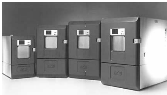
1. ábra Standard hőmérséklet kamrák
