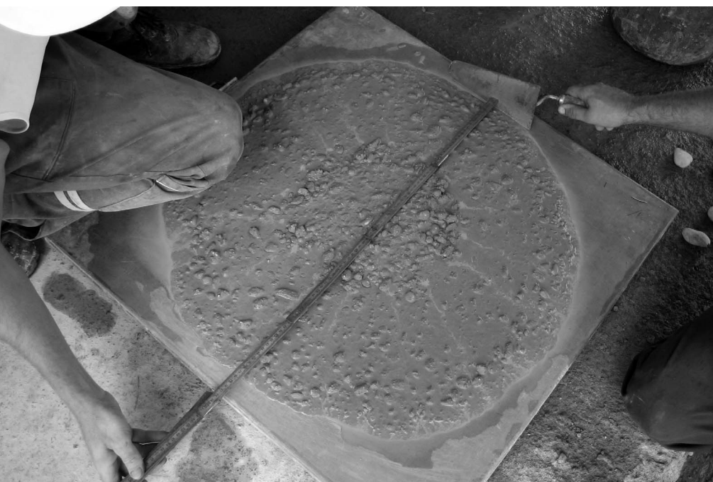
5. kép Öntömörödő beton területének mérése
