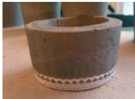
6. kép Beton virágcserepek és mintázati kísérlet (Horkai András)
