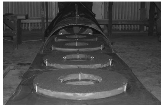
2. ábra Forszírozott szárítás a repedésképződési hajlam vizsgálatára
