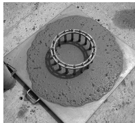
3. kép Az öntömörödő beton terürlésének mérése blokkológyűrűvel
