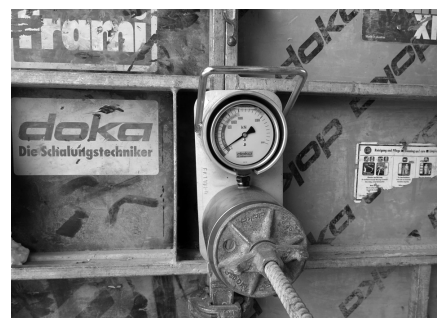
2. kép A zsaluzatot terhelő betonnyomás mérése
