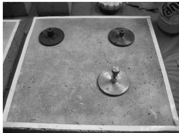
7. ábra Felragasztott „tappancsok” a felületi tapadás méréséhez
