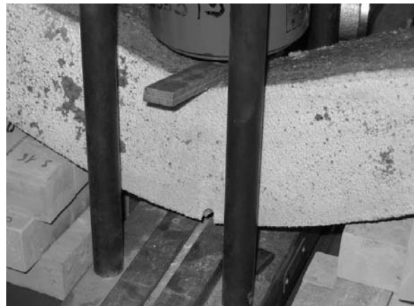
5. ábra A húzott szélső szál szakadása; 1. minta
