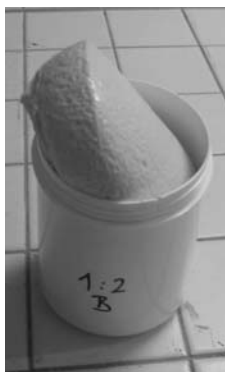
3. ábra 1:2 keverési arányú gél jelentős térfogatváltozása
