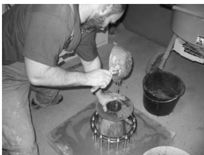
3. ábra Terülmérés Abrams kúppal J-Ring blokkolási effektussal
