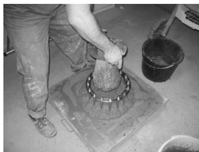
3. ábra Terülmérés Abrams kúppal J-Ring blokkolási effektussal
