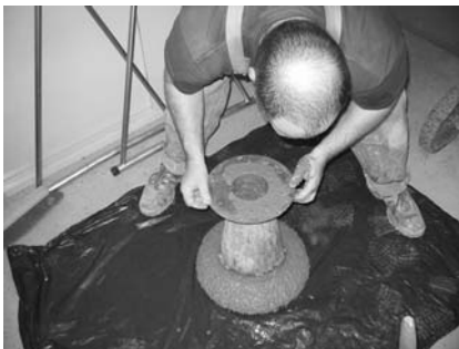
4. ábra Terülmérés Abrams kúppal 2 óras korban
