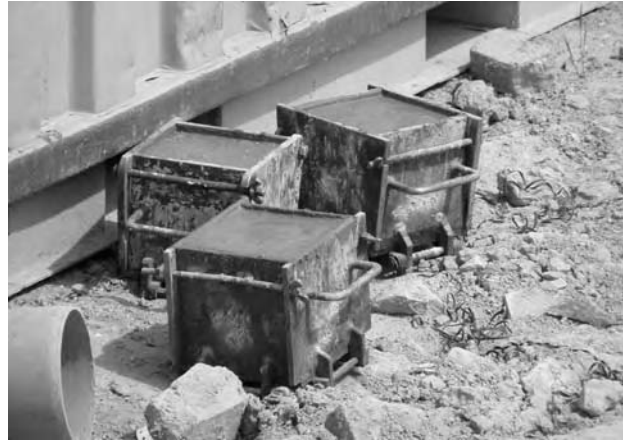
4. ábra Az építéshelyi próbakockák utókezelése
