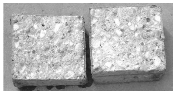
12. ábra Elhasított próbatest a fagyállóság vizsgálat után. A teljes keresztmetszet száraz
