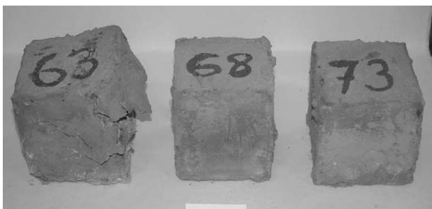
5. ábra B4 jelű, kétkomponensű bevonattal készített próbatetek a kloridos fagyasztás után
