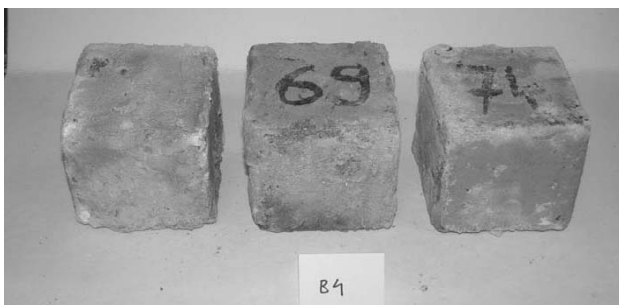
10. ábra Kétkomponensű bevonattal készített próbatetek a szulfátos kristályosítás után
