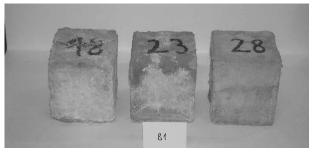
2. ábra B1 jelű, egykomponensű bevonattal készített próbatestek a kloridos fagyasztás után
