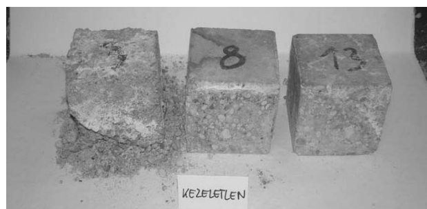
1. ábra Kezeletlen felületű próbatestek a kloridos fagyasztás után
