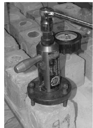
13. ábra A tapadószilárdság vizsgálata beton próbatesteken HYDRAJAWS készülékkel
