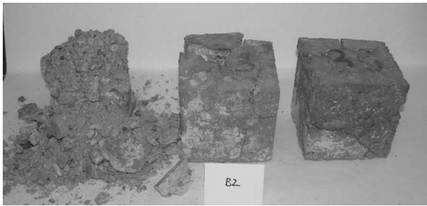
3. ábra B2 jelű, egykomponensű bevonattal készített próbatetek a kloridos fagyasztás után
