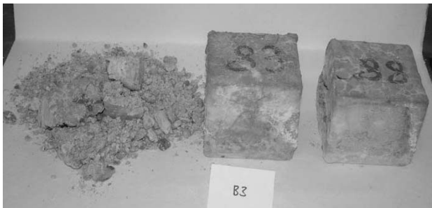
4. ábra B3 jelű, egykomponensű bevonattal készített próbatetek a kloridos fagyasztás után
