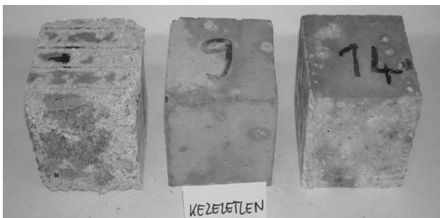
8. ábra Kezeletlen felületű próbatetek a szulfátos kristályosítás után
