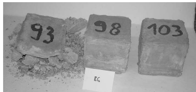
7. ábra B6 jelű, kétkomponensű bevonattal készített próbatetek a kloridos fagyasztás után
