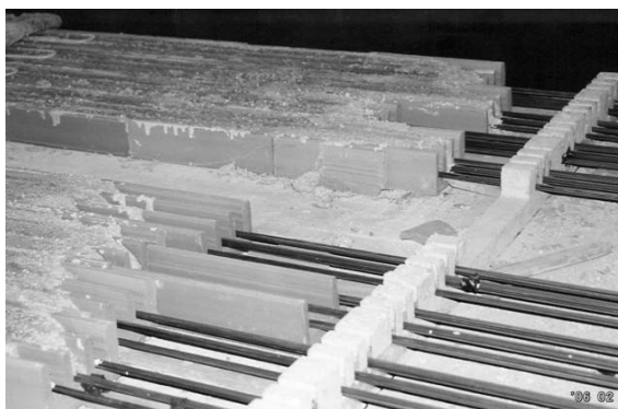
1. ábra Porotherm kerámia burkolatú feszített vasbeton födémgerenda gyártása a Wienerberger Zrt. Kőszegi Gerendagyárában
