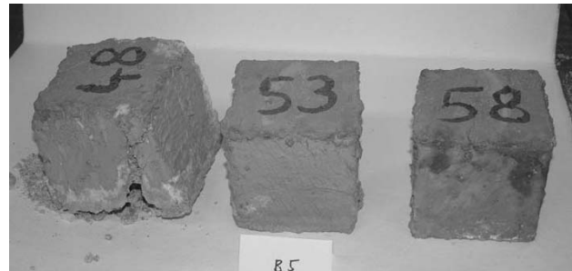
6. ábra B5 jelű, kétkomponensű bevonattal készített próbatetek a kloridos fagyasztás után
