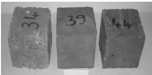
9. ábra Egykomponensű bevonattal készített próbatetek a szulfátos kristályosítás után
