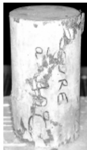
3. ábra A hőkezelés hatása az M2C ® márkanevű RPC betonra (jobbra az egyik vizsgálati próbatest)
