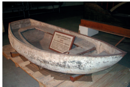
4. kép Lambot vasbeton csónakja: 1849
