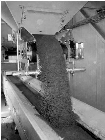
6. ábra Az adagolószalag működés közben
