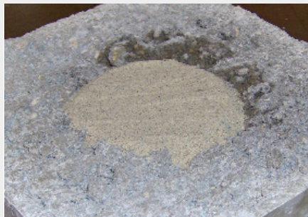
1. ábra A homokfolt módszer
