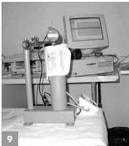
4. ábra A kötési idő meghatározása az ún. vérnyomásmérő módszerrel
