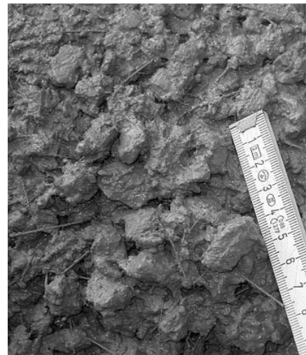
4. ábra Szálas beton whitetopping készítéséhez
