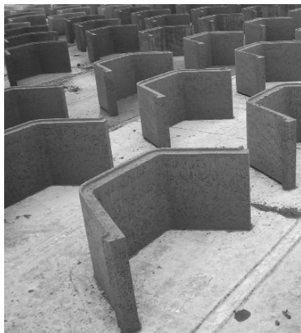
1. ábra Árokelemek a gyártótéren
