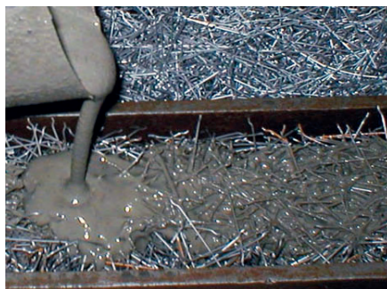
7. kép SIFCON beton készítése [10]
