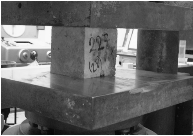
5. ábra Nyomószilárdság vizsgálat
