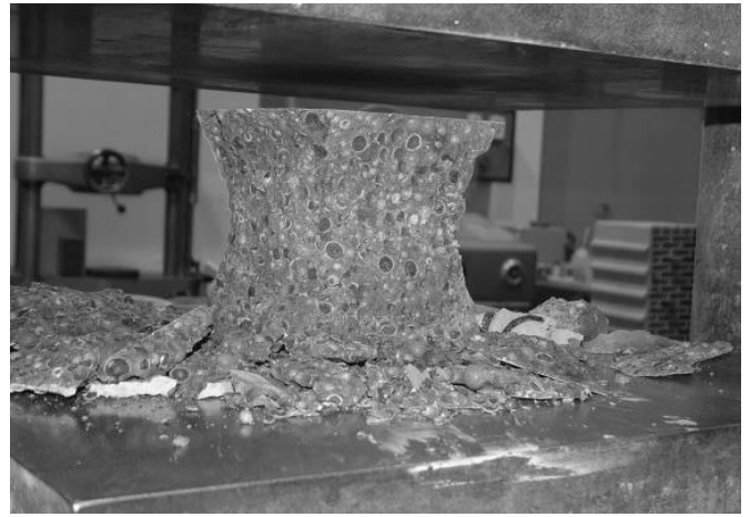
6. ábra Töréskép a nyomóvizsgálat után
