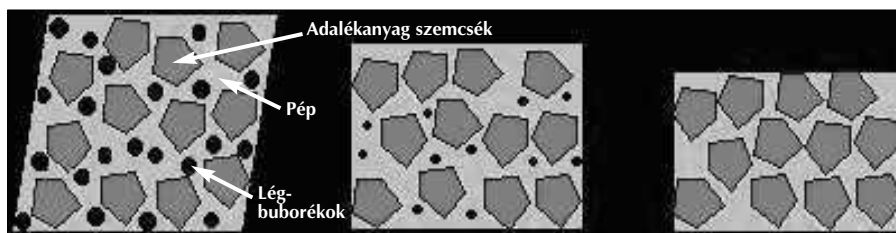
12. ábra A betonkeverék szállítás közben (bal oldalon), bedolgozást követően (középen), majd kissé később, légtelenedett állapotban (jobb oldalon)
