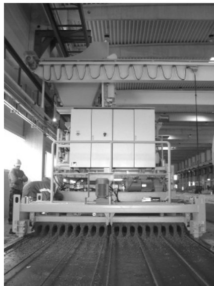
3. ábra Üreges födémpanelló gyártása
