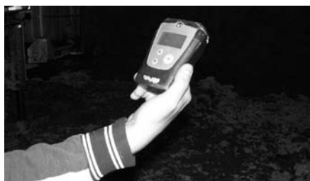
5. ábra Kézi készülék a gázkoncentráció mérésére, amelynek zöld jelzése a teljesen gázmentes levegőt jelenti
