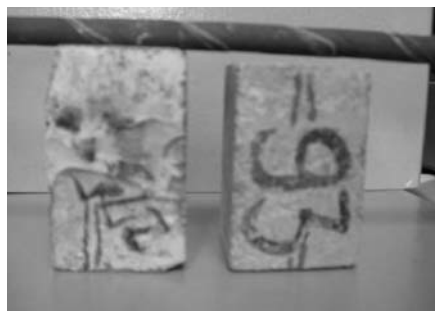
5. ábra Próbatestek a koptatás vizsgálat után (bal oldalon a normál beton, jobb oldalon a könnyűbeton próbatest)
