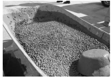
7. ábra Liapor adalékanyaggal készített beton a talicskában
