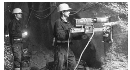
11. ábra Hengerminták vételezése lőttbeton falból
