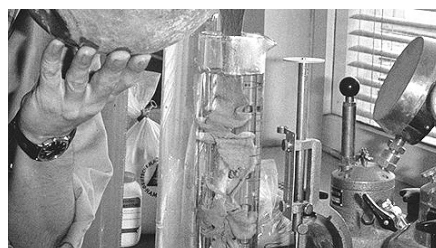
14. ábra A víztaszító tulajdonságú cementhabarcs süllyedése a vízzel telt üveghengerben
