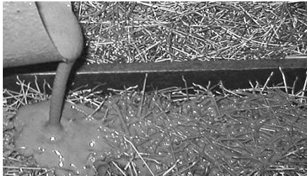
5. ábra SIFCON betonszerkezet előállítása
