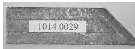
2. ábra Felrakó hegesztéssel erősített kompozit saroklapát
