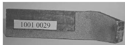
3. ábra Vídia betétes, kompozit saroklapát wolfrám-karbid bevonattal
