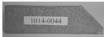
4. ábra Vídia betétes öntvény saroklapát wolfrám-karbid bevonattal
