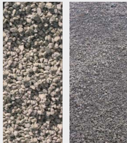
5. ábra Bontott betonszerkezetből készített adalékanyag frakciók
