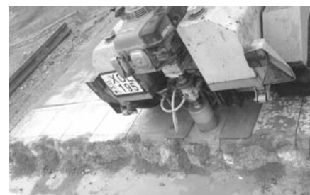
4. ábra A finiszerrel túlbúzótt részből történő mintavétel a bontás előtt
