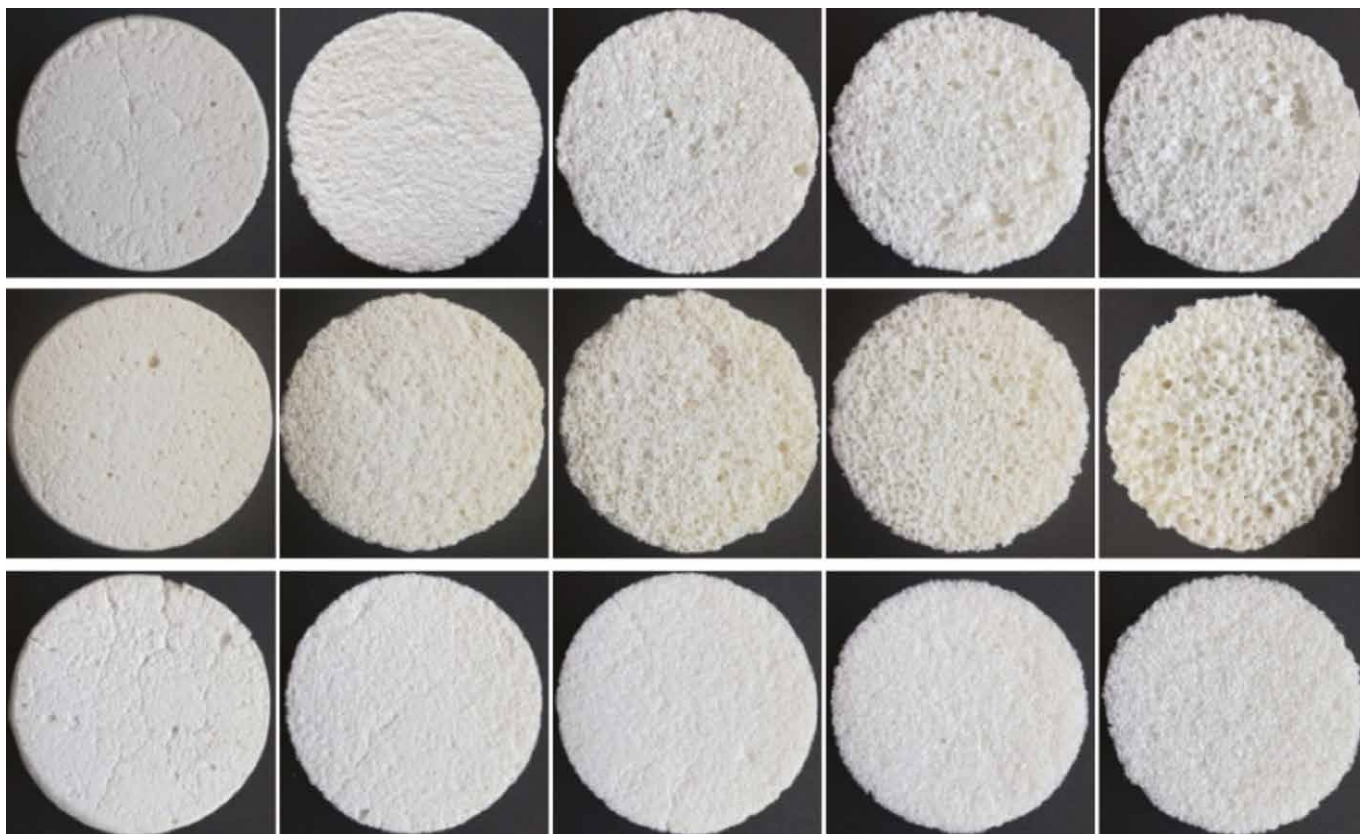
5. ábra Habosított geopolimer katalizátorhordozók morfológiája növekvő habosítószer-koncentráció mellett.
