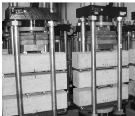
1. ábra Kúszásvizsgálat basábokon
