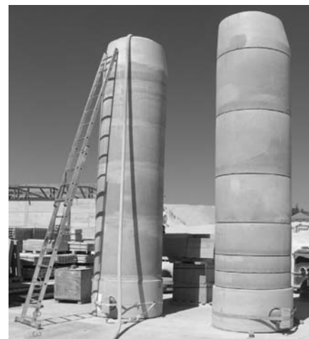
3. ábra Vízzáróság vizsgálat az 5 m magas, összeépített szennyvíz elvezető beton aknarendszereken a Dolomit Kft. gánti betonüzemében (üzemvezető és a beton összetételének tervezője Spránitz Ferenc okl. építőmérnök, betontechnológus)
