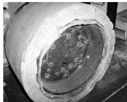
3. ábra Javítatlan dilatáció következményei: idő előtti kerékcseré, csökkenő raktári teljesítmény, targoncavezetői eu-problémák, folyamatos pénzkidobás
