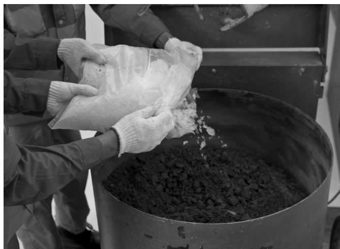
2. ábra Az adalékanyag felforrósodását aprított jég bekeverésével is megakadályozhatjuk
