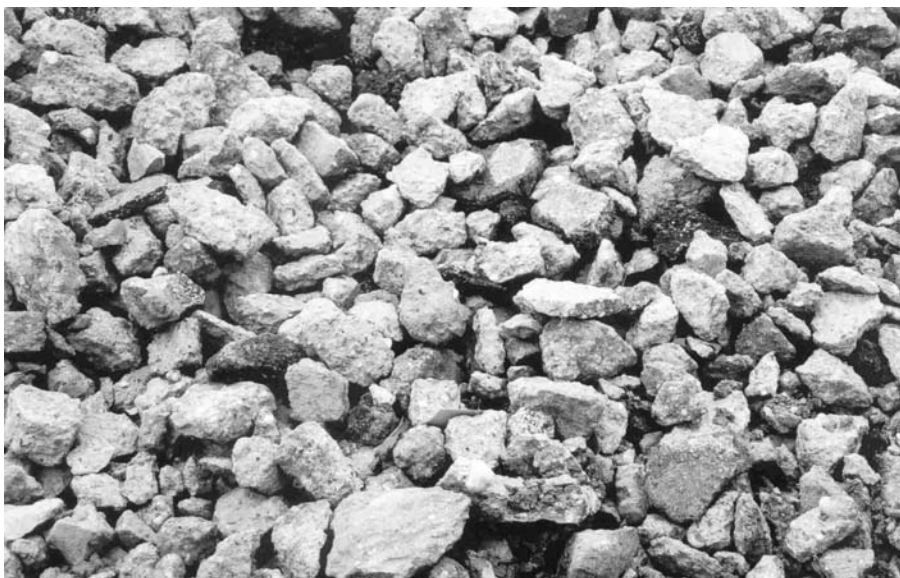
2. ábra Bontott betontörmelék
