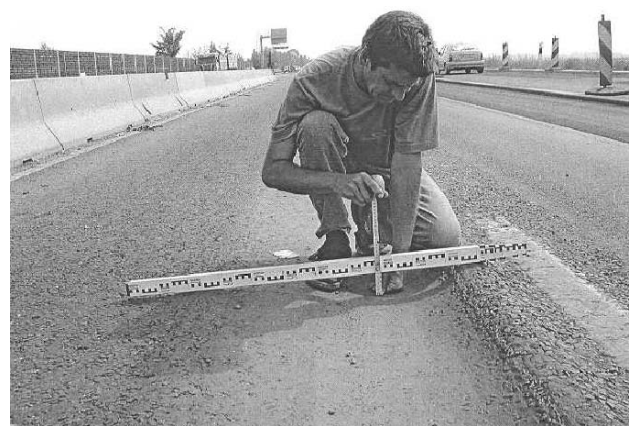
4. ábra Nyomvályúmérés az M0 autópályán
