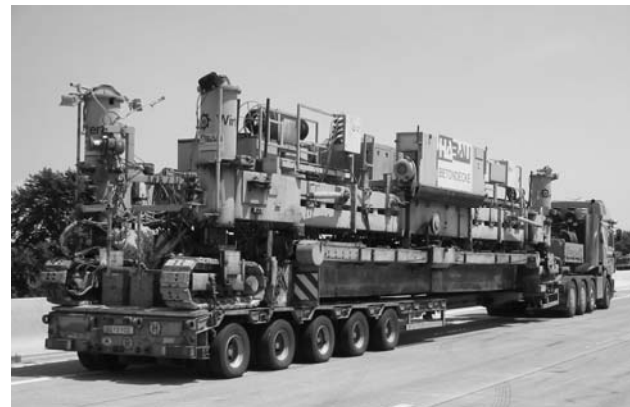
2. ábra Útépítő gép szállítása
