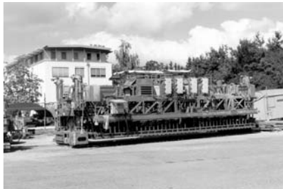
2. ábra A betonszönyeg terítésének legfontosabb eleme bevetésre kész
