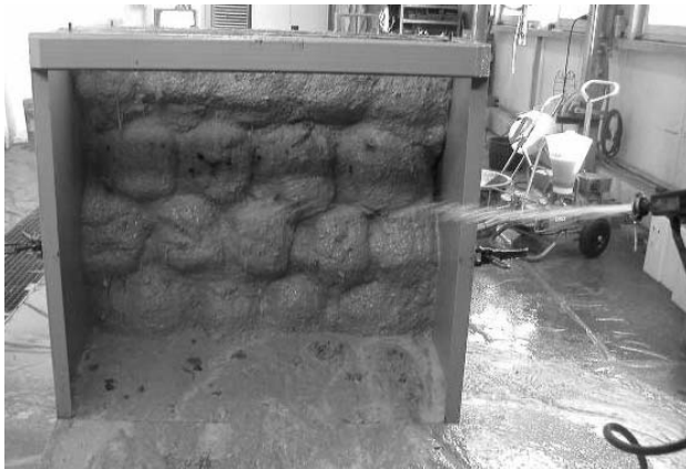
1. ábra Lassan kötő anyaggal készült hátűrinjektálás.
