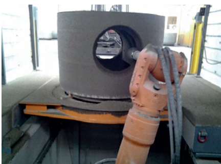
1-3. kép Tetszőleges kialakítású folyásfenéket és csőcsatlakozásokat készít a robot igen nagy pontossággal
