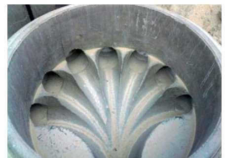
1-3. kép Tetszőleges kialakítású folyásfenéket és csőcsatlakozásokat készít a robot igen nagy pontossággal
